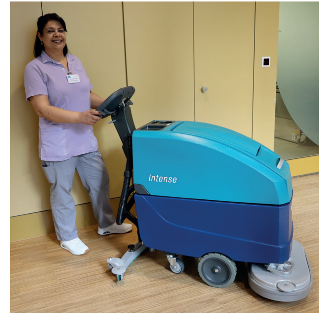
Die Reinigung mit der Scheuersaugmaschine nimmt wöchentlich einmal einen halben Tag in Anspruch.
